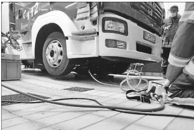
Anheben des StLF mithilfe von Hebekissen Foto: Dennis Akbaba
